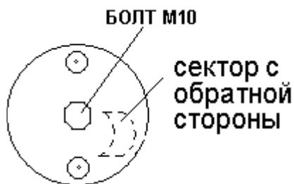
Данное положение сектора и данное положение рычага соответствуют положению стрелы «открыто», т.е. вертикальному. Для регулировки положения сектора надо ослабить центральный болт М10 и повернуть диск управления концевиками в нужное положение и затянуть болт М10
