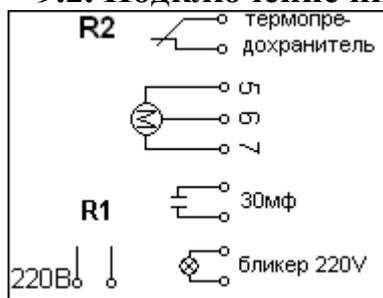
**Внимание!** При правильном подключении двигателя круг концевых выключателей на редукторе должен вращаться против часовой стрелки. При неправильном направлении вращения поменяйте провода на клеммах 5,6 местами.
