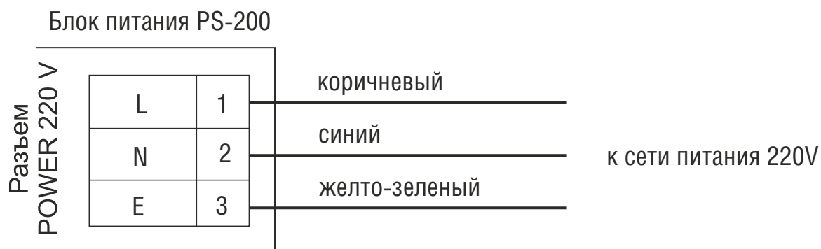
Рисунок 7.6.1 Схема подключения блока питания
