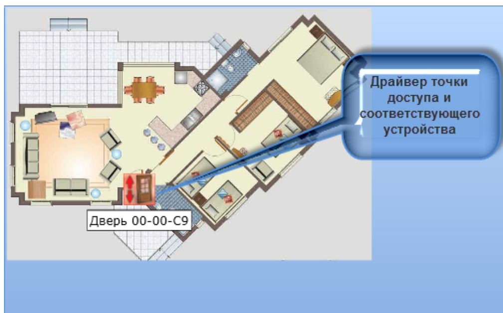
Рисунок 135 - APM RusGuard. Модуль Планы. Схема с размещенным на ней драйвером устройства "дверь"
