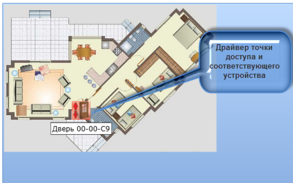
Рисунок 139 - АРМ RusGuard. Модуль Планы. Схема с размещенным на ней драйвером устройства "дверь"
