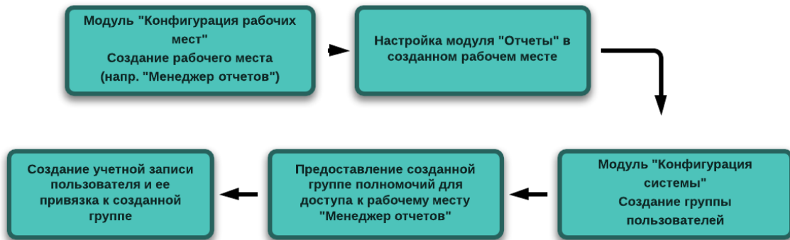
Рисунок 7 - Общая процедура создания учетной записи оператора АРМ и с определенным уровнем доступа (менеджер отчетов).
