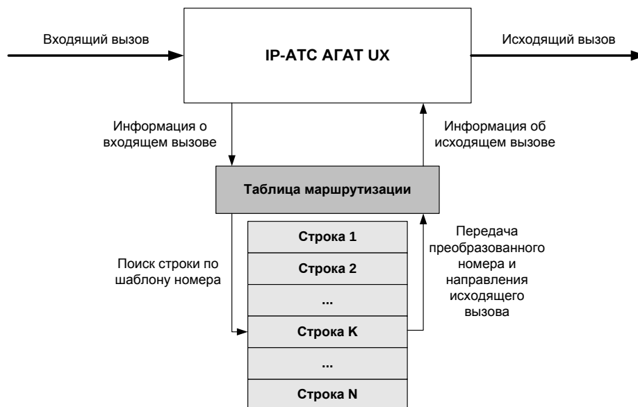
Рис. 51 – Схема обработки входящих вызовов с помощью таблицы маршрутизации
