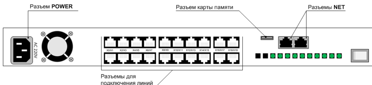
Рис. 27 – Разъемы на задней панели IP-ATC АГАТ UX-3410S
